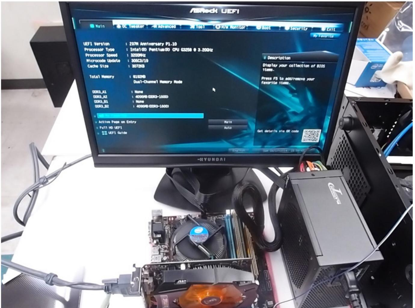
特に問題なく起動すればこれまでの取り付けは成功です。異常のあった時は一旦電源を落としてから、再度取り付け作業をやり直します。この時点で動作チェックを行っておく事で、CPU、メモリの取り付けが確実にいられたかを確認すると同時に、もし取り付け不良が合った場合でもマザーボードをケースに組み込んだ後に比べ、作業スペースを広く取る事ができ、修正も楽に行えます。
