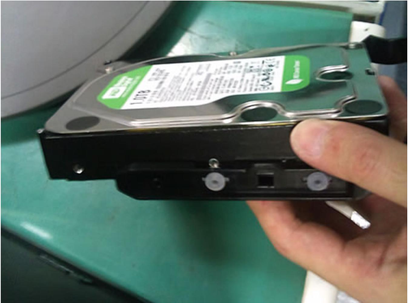
2-4. マウンターに取り付けたHDDをケース内に取り付けます。
