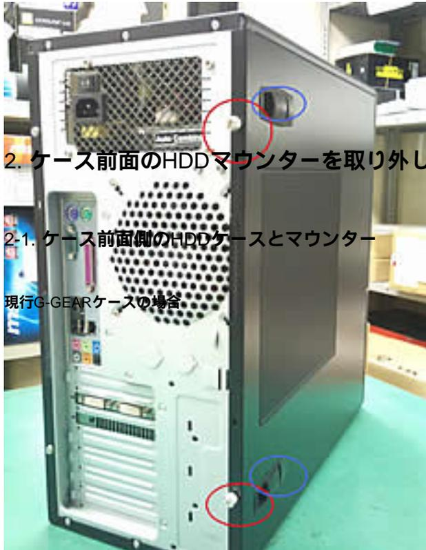
2. ケース前面のHDD マウンターを取り外し、HDDをセットします。
