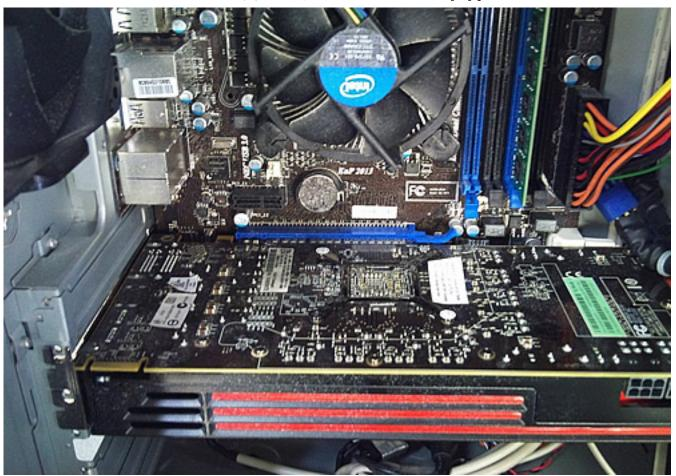
5.写真のように、ケースフレームへネジで固定します。
