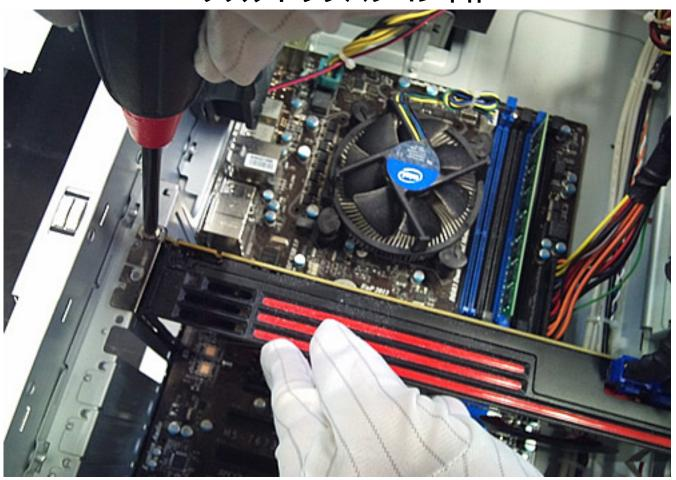
モデルによっては、取り付け用ネジが別売りとなります、あらかじめご用意ください。規格 に合わないネジを使用しますとケースが破損したり、正常に動作しない場合があります。
