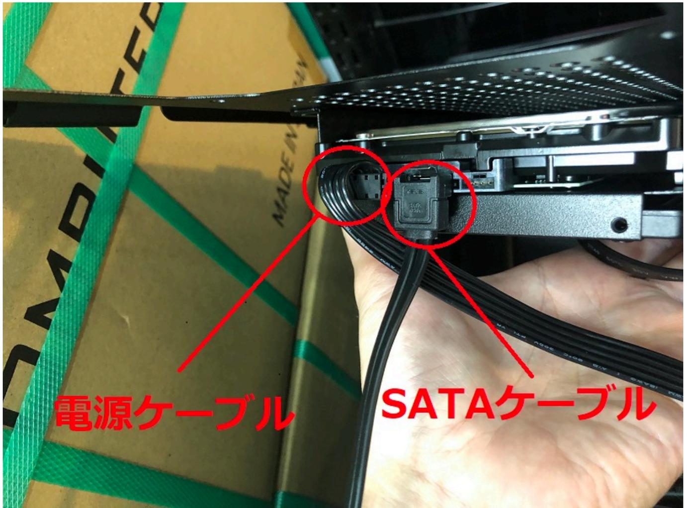
ケーブルを差し込むときは、ケーブルの向きにご注意ください。無理に差し込むとコネクタを破損する恐れがあります。また、ピンが折れないようにコネクタをまっすぐにして差し込んでください。（ポートの挿し口や形状はマザーボードにより異なります）
