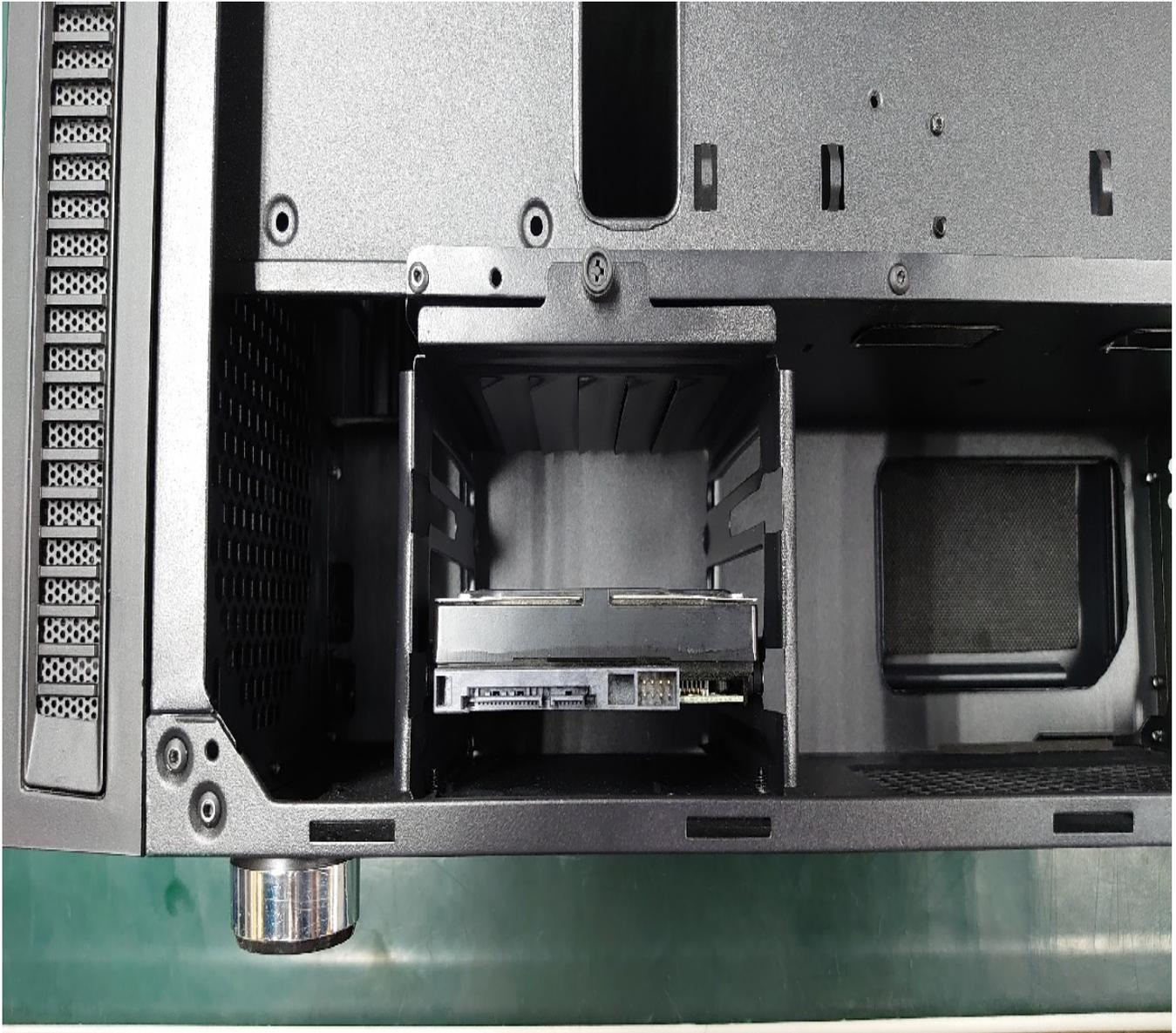
5.HDDにSATAケーブルと電源ケーブルを挿します。
