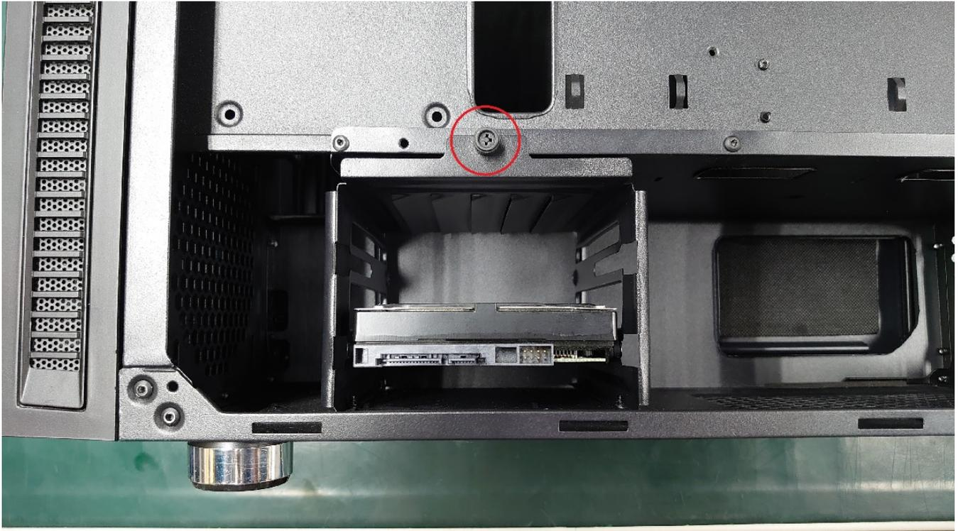
4.HDDマウンターに、HDDをセットします。
