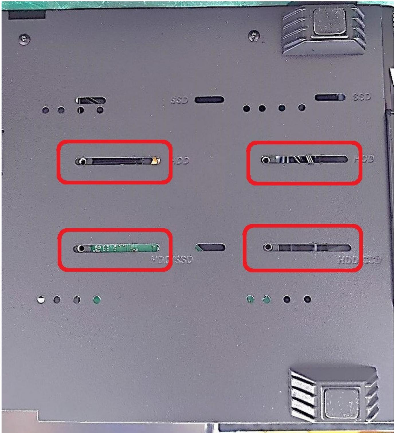
6. HDDをインチねじを使用して固定します。
