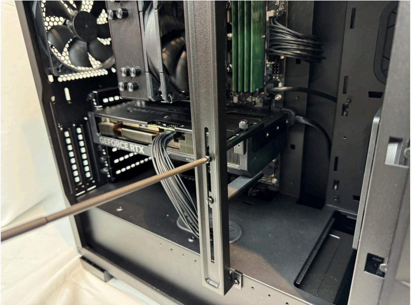
5. 側面からの支えパーツが緩い場合には、支えパーツをグラフィックボードに押し付けながら手回しネジで位置を調整してください。
