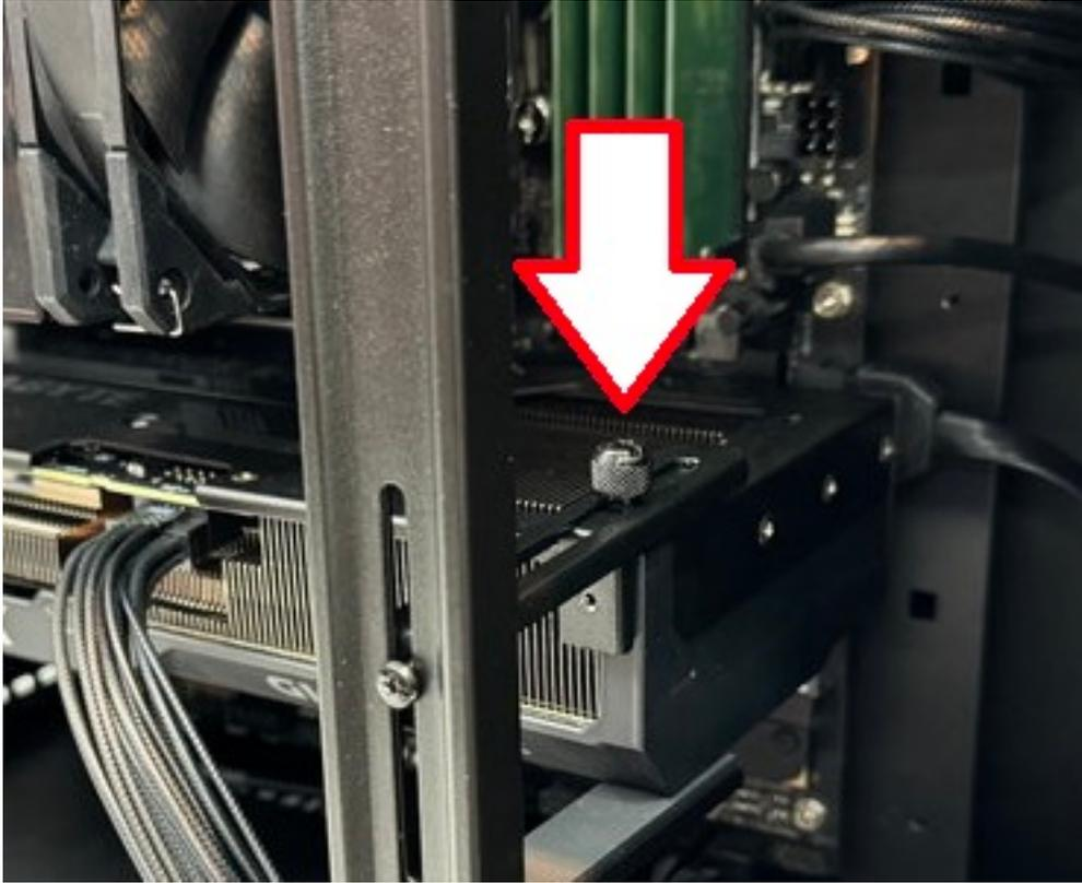
6. グラフィックボードがGPUサポートホルダーで固定され、動かない状態になっていることを確認してください。
