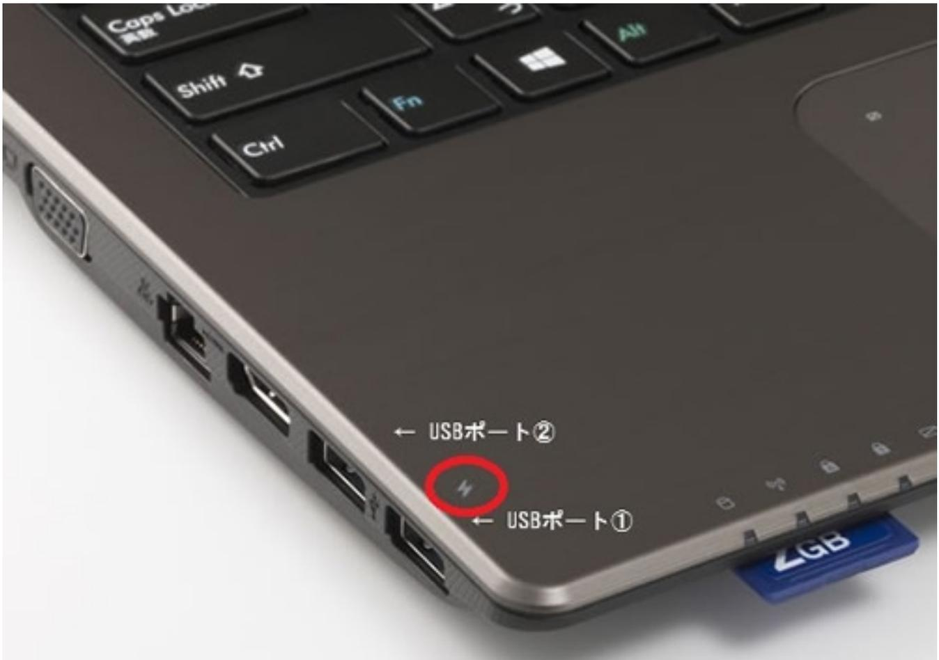
写真赤丸部分の**給電マーク**がついているUSBポート(USBポート②)に、USB電源ケーブルを挿してください。USB信号ケーブルはUSBポート①に接続します。
