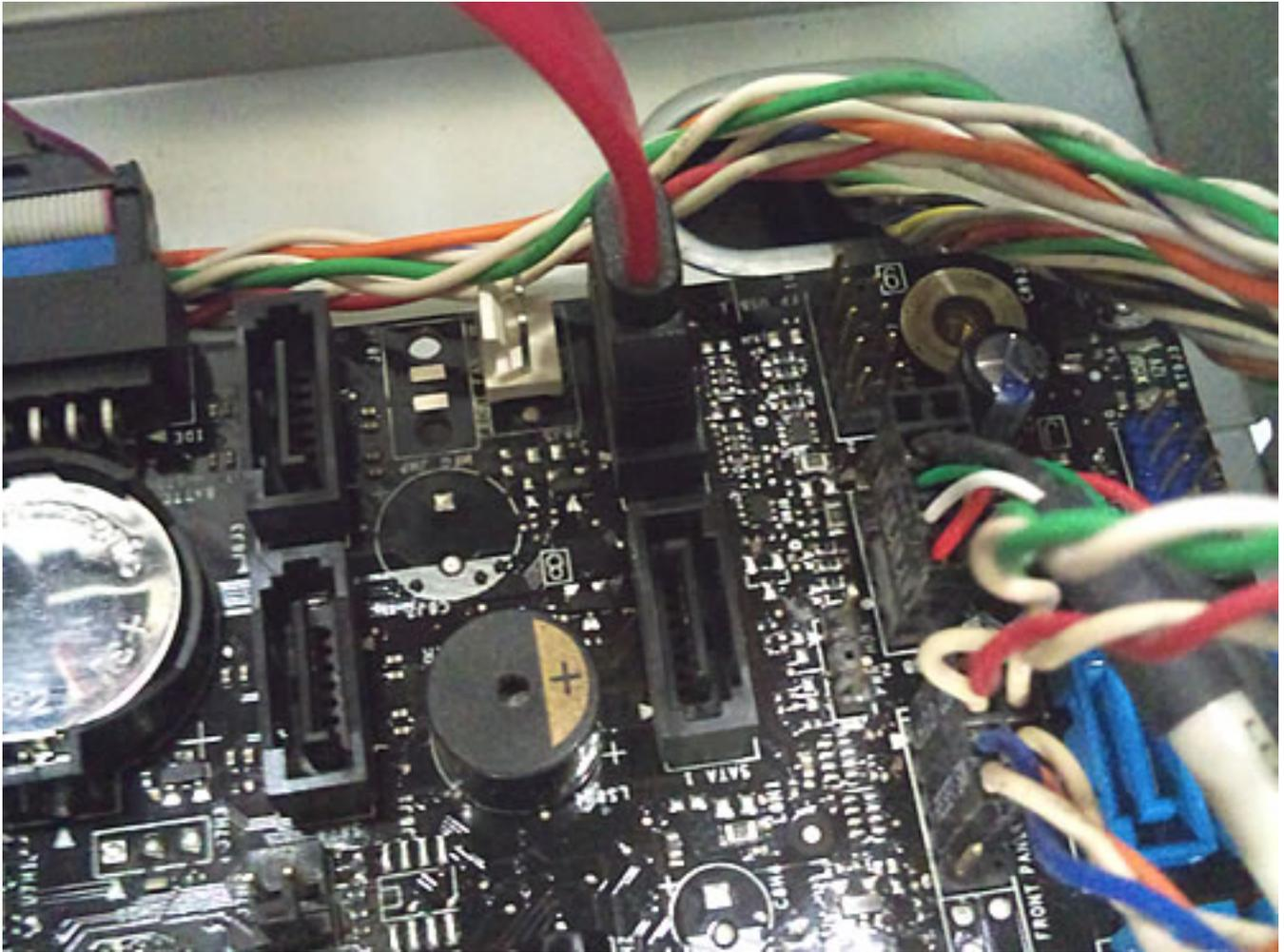
ケーブルを差し込むときは、ケーブルの向きにご注意ください。無理に差し込むとコネクタを破損する恐れがあります。また、ピンが折れないようにコネクタをまっすぐにして差し込んでください。接続が完了したら、パネルを元通りにはめなおして作業完了です。
