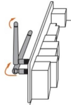
PC背面にあるアンテナ用コネクタ（2カ所）に接続します。
