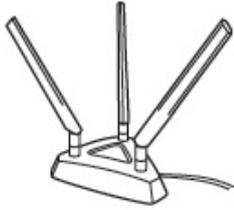
3本のロッドアンテナをアンテナベースに廻しながら取り付けます。
