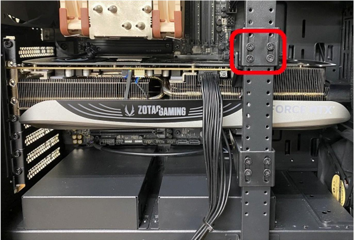
6. 側面からの支えパーツが緩い場合には、支えパーツをグラフィックボードに押し付けながら手回しネジで位置を調整してください。
