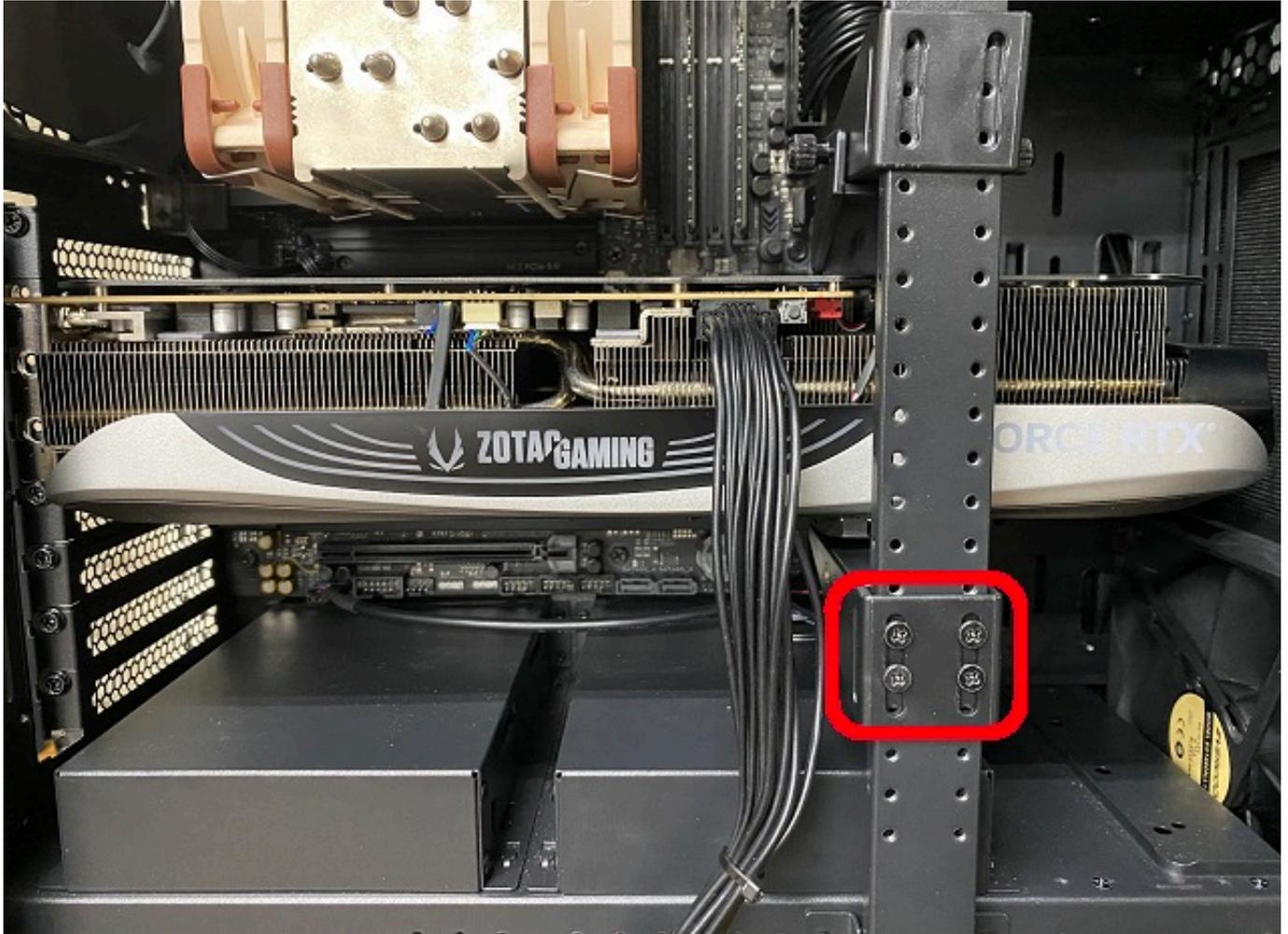
5. 上側の押さえ部品を、上から押さえつけるように挟んでネジ(計4個)で固定してください。
