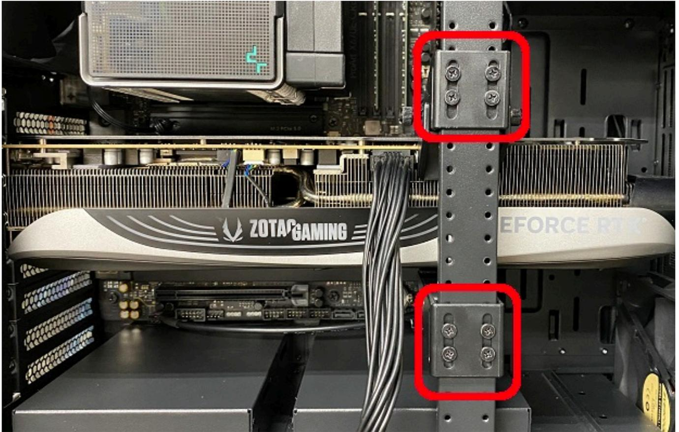
3. 支柱をケースに固定している、赤色で囲んだ箇所のネジ(計4個)を取り外します。
